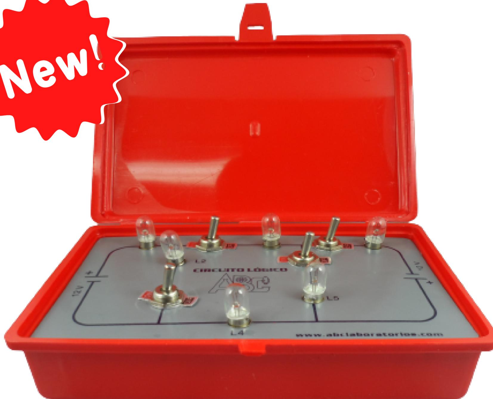
Circuito sencillo que permite generar el encendido y apagado de lámparas de bajo consumo, mediante la apertura o cierre de interruptores.
