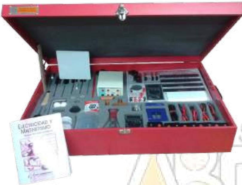
El equipo de electricidad y magnetismo avanzado ha sido diseñado para llevar a cabo el estudio de la electricidad a un nivel superior mediante experiencias de complejidad alta. Está compuesto por dispositivos que permiten realizar procesos experimentales con niveles de tensión y corriente seguros para el usuario, permitiendo el acercamiento a elementos cotidianos.
