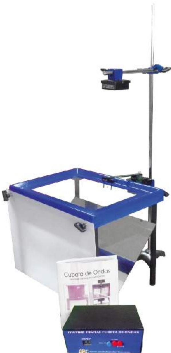
Cubeta de ondas UNIVERSAL, equipo con diferentes componentes que ensamblados conforman una cubeta de ondas tradicional, además cuenta con un sistema de control digital; que permite generar diferentes ondas por medio de la fuente vibradora y del estroboscopio, generando una mejor experiencia de trabajo.
