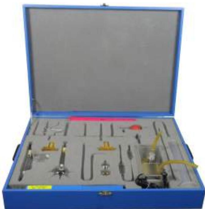
Este novedoso equipo para el estudio de fenómenos hidráulicos permite demostrar principios básicos de hidrostática como presión en fluidos y su relación con la presión atmosférica, principio de Pascal y flotabilidad de cuerpos según Arquímedes. Así mismo permite realizar el estudio de fluidos en movimiento y los efectos de la viscosidad.
