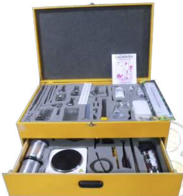
Esta nueva versión del equipo de calorimetría cuenta con todos los accesorios necesarios para llevar a cabo el estudio de los cambios de temperatura, equilibrio térmico y el comportamiento del calor, así como los métodos de transferencia y efectos sobre sistemas sólidos, líquidos y gaseosos, tales como la dilatación y la ebullición.
