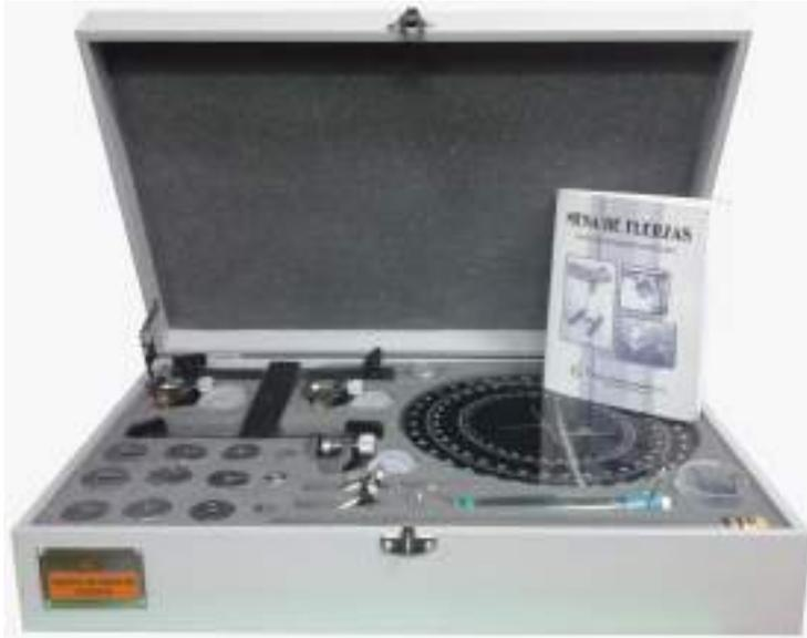
Este equipo de fácil montaje permite llevar a cabo el análisis vectorial de tensiones en cuerdas mediante la interacción de diferentes pesos. Así mismo es posible realizar el análisis de más de dos fuerzas mediante diversos ángulos. Incluye además la posibilidad de tomar medidas mediante dinamómetros de diferentes valores.
