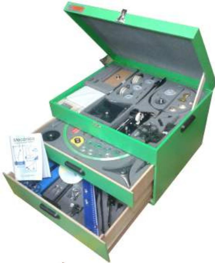
Este equipo se compone de diversos elementos que permiten llevar a cabo el proceso de experimentación en las áreas de metrología y sistemas de unidades básicas, cinemática en una y dos dimensiones, dinámica, estática, transformación y conservación de energía. El equipo incluye aro de Müller para análisis de movimiento circular uniforme y momento rotacional de diferentes tipos de sistemas.
