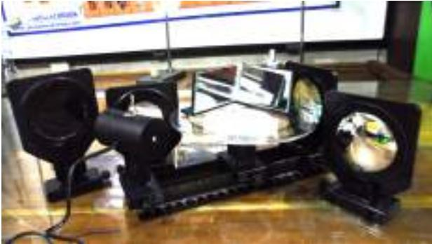
Kit de óptica geométrica, ideal para desarrollar prácticas de fenómenos ópticos. Cuenta con los elementos fundamentales para poder desarrollar prácticas experimentales como son fuente de luz doble, soporte metálico para realizar los diferentes montajes, espejos con diferentes curvaturas, lentes, placas con diferentes figuras, elementos en carcasas plásticas que permite acoplarse al soporte de montaje, 14 piezas del kit.
