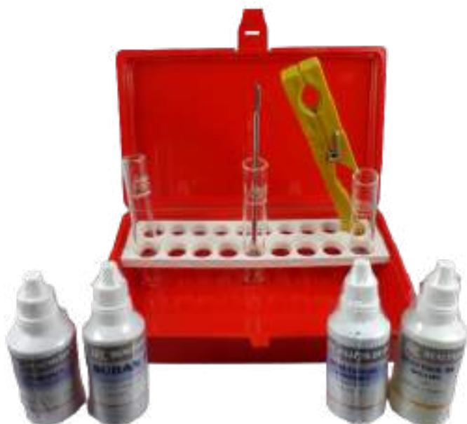
*Permite identificar de manera rápida la presencia de Proteínas, Carbohidratos y de Lípidos en una muestra. La identificación se hace de manera cualitativa por precipitación de la sustancia en el tubo de ensayo.*
