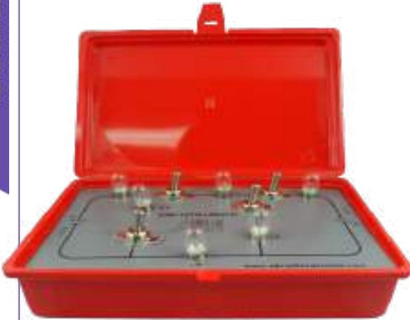
Circuito sencillo que permite generar el encendido y apagado de lámparas de bajo consumo, mediante la apertura o cierre de interruptores.
