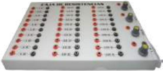
De gran aplicación en laboratorios para la medición de resistencias eléctricas.
