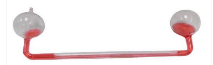
Elemento que permite observar la ebullición de mezclas de líquidos a baja temperatura, por acción del vacío y la dilatación del aire. Con la palma de la mano agarre suavemente alguno de los bulbos de vidrio, y espere a que la temperatura de la mano caliente el líquido, este se desplazará por el conducto hasta el otro bulbo
