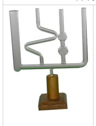
Útil para observar la igualdad del nivel de un líquido depositado en tubos ramificados de diferentes formas Material : vidrio
